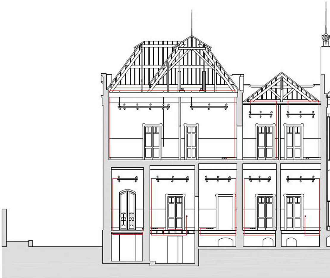
FIGURA 1 – Esquema do Novo Conceito de Iluminação. Fonte: Prancha A-12/12, Universidade de São Paulo, Faculdade de Arquitetura e Urbanismo, Edifício Vila Penteadado, Corte 2, junho de 2004, Escala 1:250, Estagiários Pedro Saito, Rafael Ramos e Vanezza Grossman. Desenho apresentado no Relatório de Gestão de 2006 da Vila Penteadado.
