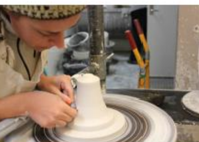
8. Logo após a reação exotérmica do gesso é dado o acabamento na superfície do modelo, alisando a superfície e fazendo pequenas correções na base para evitar pontos de retentividade (importante na etapa de reprodução do molde).
