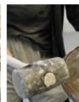
5. Para quebrar o molde serra-se 1cm da parede do molde, colocam-se 2 chapas de metal finas onde foi serrado e uma terceira chapa entre estas duas. Com a ajuda de um martelo de borracha, delicadamente, vai batendo na terceira chapa até o molde rachar.
