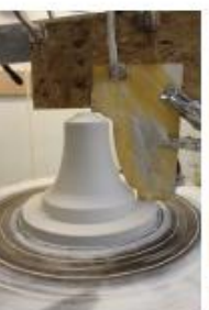
8. Modelo em gesso aguardando secagem para acabamento.
