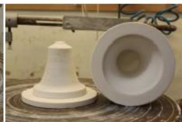
2. Aqui se repetiram as etapas 4, 5, 6 e 7 do Anexo II para fazer o molde a partir do modelo do sino em gesso.
