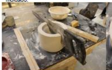
3. Serrando o molde em duas partes.
