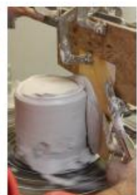
7. Liga-se o torno e aproxima-se o perfil para dar forma ao gesso ainda mole.
