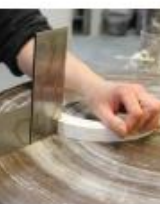
5. Para quebrar o molde serra-se 1cm da parede do molde, colocam-se 2 chapas de metal finas onde foi serrado e uma terceira chapa entre estas duas. Com a ajuda de um martelo de borracha, delicadamente, vai batendo na terceira chapa até o molde rachar.
