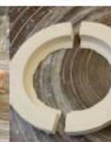
5. Para quebrar o molde serra-se 1cm da parede do molde, colocam-se 2 chapas de metal finas onde foi serrado e uma terceira chapa entre estas duas. Com a ajuda de um martelo de borracha, delicadamente, vai batendo na terceira chapa até o molde rachar.
