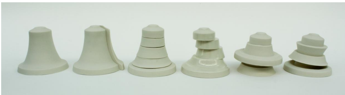
Coleção de objetos em porcelana mostrando as possibilidades na variação de recortes e combinações. Todos queimados em forno elétrico a 1280°C, sem esmalte com exceção do terceiro da direita para a esquerda, que foi esmaltado com transparente.
